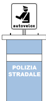
Figura 9: box autovelox mobile per cantiere di lavoro (tipo standard approvato dalla Polizia Stradale)
