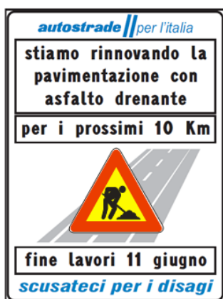
Figura 6: esempio di pannello composito di informazione modificabile con lamierini realizzato su cavalletto e avente dimensioni non inferiori a 3 mq. Posizionamento sul margine destro o sinistro delimitato da coni o delineatori flessibili dopo la prima testata di riduzione corsia. Da prevedere per lavori di particolare impatto su richiesta della Direzione di Tronco.
